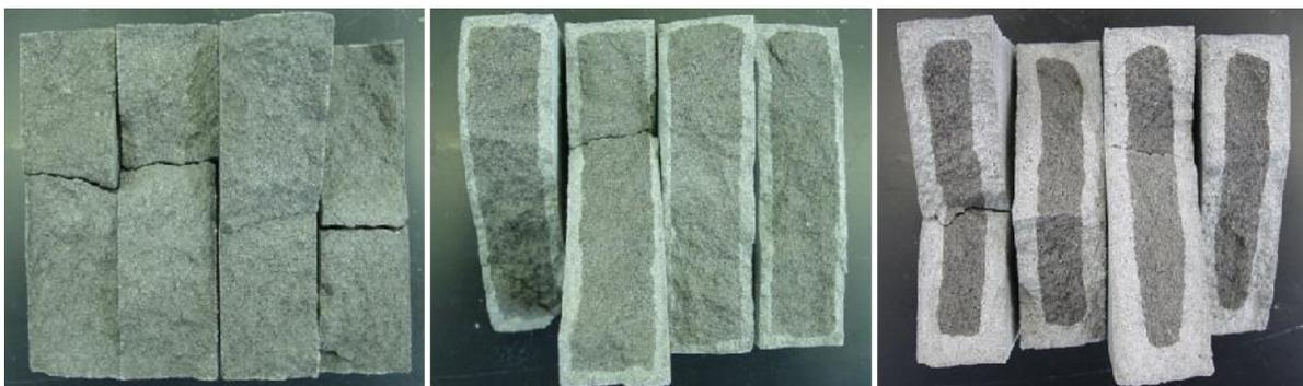
写真3. 浸透深さ状況(左側より無処理、トスパリア200、WRC3279)
