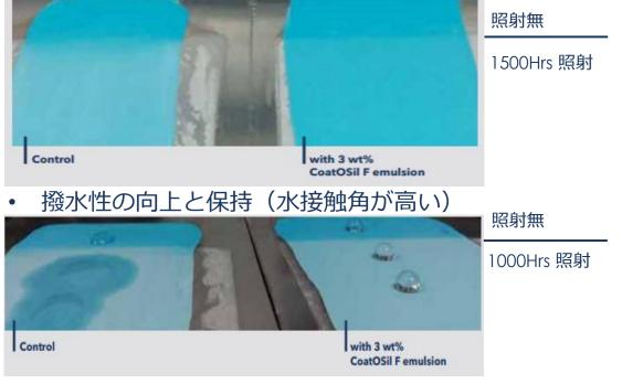
Left: Control: High PVC Commercial paint without CoatOSil F Right: Post adding 3% CoatOSil F 1500Hr/1000Hrs accelerated weathering test 注:テストデータ、実際の結果は異なる場合があります。
